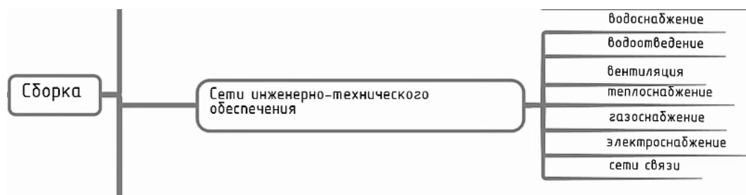
Рис. 1.24. Системы инженерно-технического обеспечения
